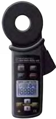
Strommesszange zur Erdschleifenmessung
